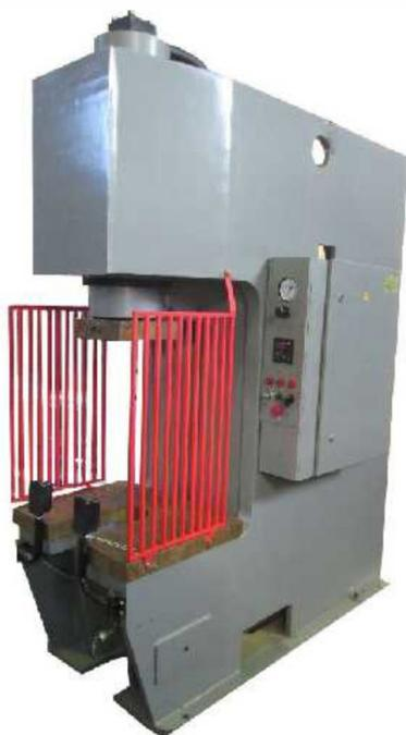
Прессы гидравлические одностоечные относятся к универсальному виду оборудования для выполнения различных операций обработки давлением. Основными операциями, выполняемыми на прессе, являются монтажно-запрессовочные, штамповочные, прошивочно-калибровочные, рихтовочные.
