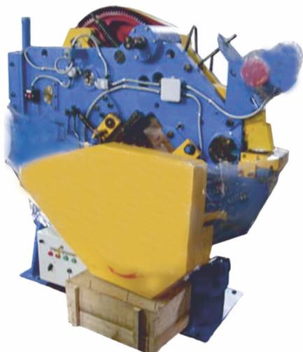
Пресс-ножницы комбинированные HB5221 предназначены для отрезки полосового, сортового и фасонного проката, пробивки отверстий в листовом, полосовом и фасонном прокате, а также вырубки открытых пазов.
