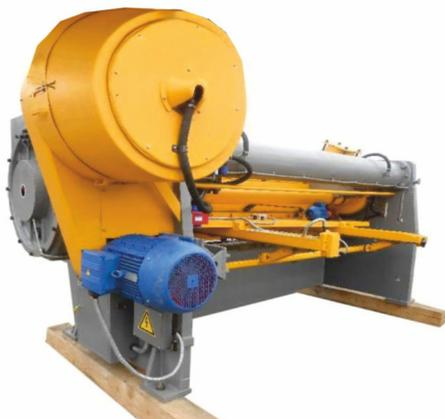
Гильотинные ножницы применяются в заготовительном производстве для рубки листового металла различной ширины, длины и толщины на заготовки требуемых размеров. Некоторые виды гильотинных ножниц также имеют возможность разрезать фасонный и сортовой прокаты.
