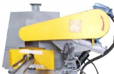
Абразивно-отрезной станок 8Г240 предназначен для резки отрезными черными металлами различных профилей на мерные длины с помощью абразивных кругов.
