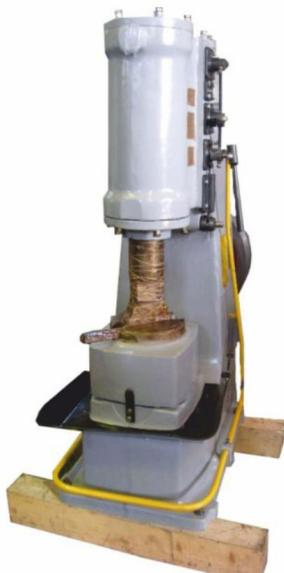
Молота ковочные пневматические предназначены для горячей объемной штамповки поковок из черных, цветных металлов и сплавов. На молотах можно штамповать детали и заготовки различных конфигураций, применяющиеся в промышленности
