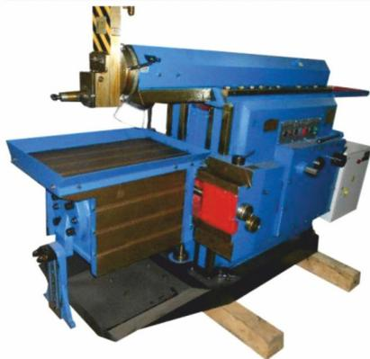
Поперечно-строгальные станки могут быть использованы в ремонтных и производственных цехах и мастерских для выполнения строгальных работ на горизонтальных, вертикальных и наклонных поверхностях (как плоских так и фасонных), на станке могут выполняться прорезания пазов, канавок.
