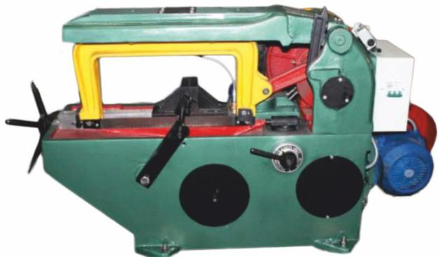
Станок ножовочный 8725. Пред-назначен для отрезки круглого и профильного материала из стали, чугуна и цветных металлов машинным ножовочным полотном для металла.
