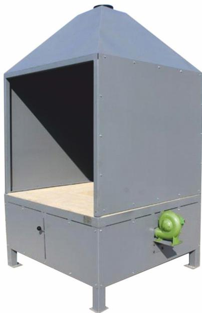
Горн кузнечный оборудован дутьевой системой от вентилятора модели VT1-3, подом из огнеупорного кирпича, устройством сбора и удаления золы и естественной вытяжной вентиляцией. Дутьевая система состоит из зольной камеры, заполненной стальной и чугунной стружкой, которая
